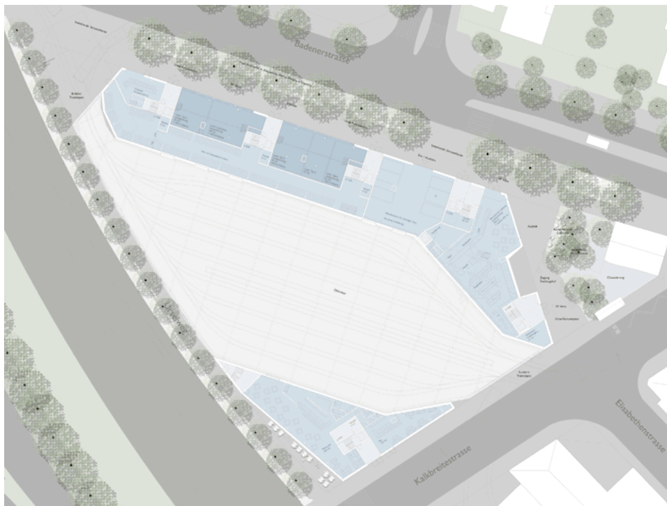
Grundriss EG und Umgebung: der Bau erstreckt sich über 2 Baufelder entlang der Badenerstrasse und in der Ecke Kalkbreitestrasse/Urselweg (blau). Dazwischen die Tram-Abstellanlage (hellgrau). Der Plan zeigt die an der Badenerstrasse vorgesehene Fahrspurreduktion stadteinwärts und die neue Baumreihe
