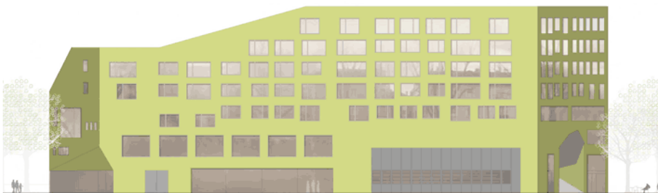
Ansicht Kalkbeitestrasse mit Zugang Terrasse (ganz rechts), Einfahrt Tramabstell-anlage (Mitte rechts) und Restaurantfront mit zugehörigem Aussenraum (links).
